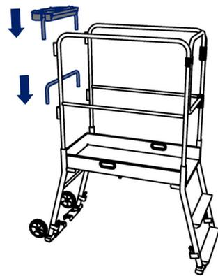
**5** Assembler la tablette et la lisse sur les garde-corps. Ces 2 éléments peuvent être inversés selon le besoin.
