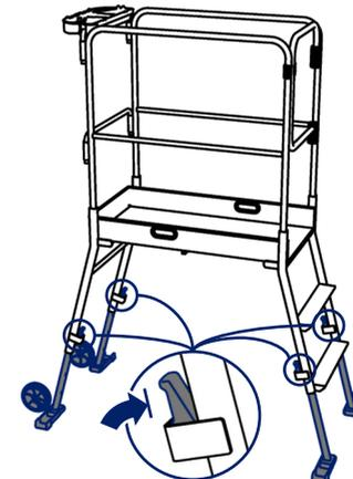
**7** Régler les 4 pieds de la plate-forme à la hauteur souhaitée. La sortie est automatique. Pour rentrer les pieds, appuyer sur les verrous d'un piétement, et accompagner la descente de la plate-forme jusqu'au verrouillage.
