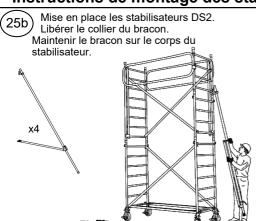
Stabilisateur à la verticale, accrocher la 26b partie haute au barreau décrit dans le tableau de position des stabilisateurs suivant la gamme de Docker (voir sommaire).
