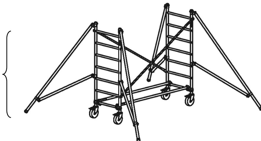
Le module de base et le module de 1m sont présents une seule fois sur les hauteurs paires. Le module d'élévation de 2m peut se répéter suivant la composition et n'est pas présent sur la hauteur 1,9m. Pour passer d'une hauteur paire à une hauteur impaire, vous devez positionner un module de 2m au dessus du module de base et continuer le montage si nécessaire.
