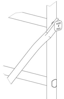
Pour le démontage appuyer sur le bouton et tirer sur la diagonale
