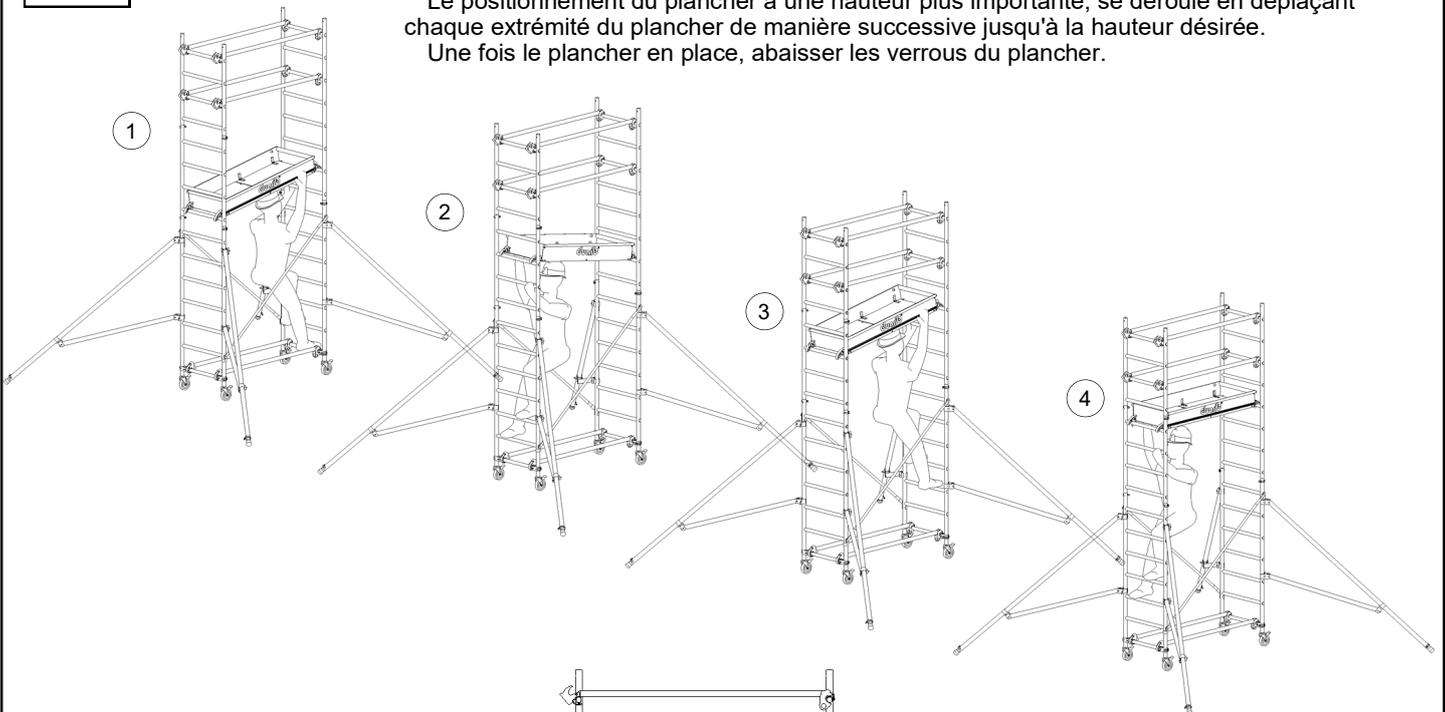
Les crochets du plancher permettent le décalage d'un barreau maxi.
