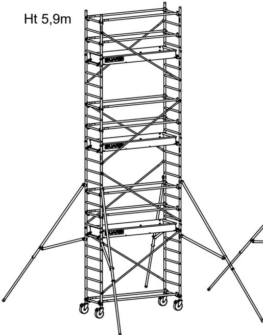
On parle de hauteurs paires, quand le plancher le plus haut est positionné à 1,8m - 3,8m du sol pour AL135 - AL165 et 1,9m - 3,9m - 5,9m - 7,9m du sol pour AL205 - AL255 - AL300.
