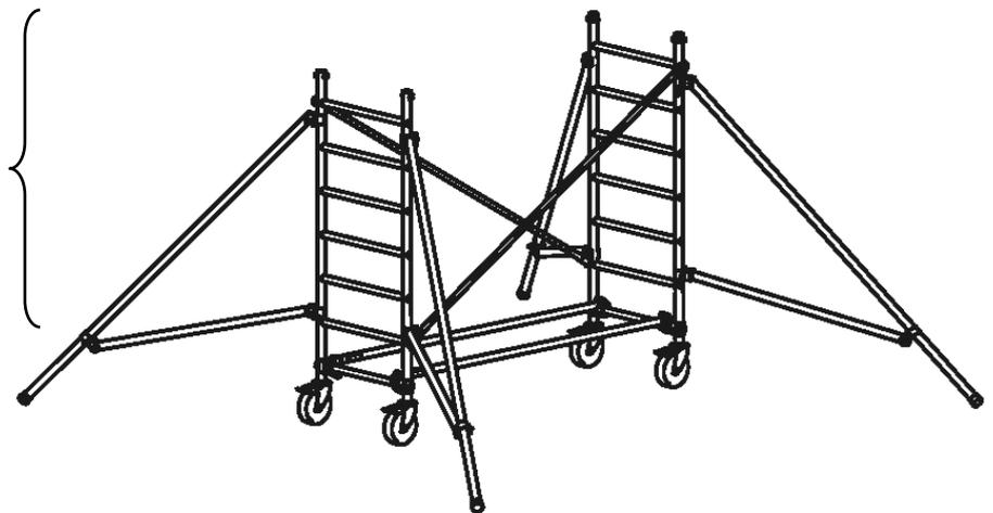
Le module de base et le module supérieur de 2m sont présents une seule fois sur les hauteurs impaires. Le module d'élévation de 2m peut se répéter suivant la composition et n'est pas présent sur la hauteur 2,9m. Pour passer d'une hauteur impaire à une hauteur paire, vous devez positionner un module de 1m au dessus du module de base et continuer le montage avec des modules d'élévation de 2m si nécessaire.
