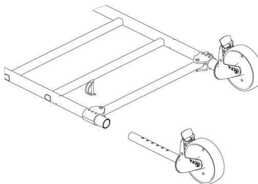
Ajuster le réglage des roues avec les trois trous pour un réglage tous les 10 mm.
