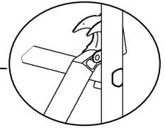
Utiliser le bout de la diagonale, engager celui-ci dans l'autre extrémité de la lisse.
