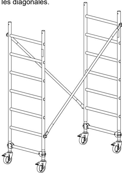
Appuyer sur le bouton et insérer l'extrémité de la diagonale jusqu'en butée dans le sertissage de l'échelle.
