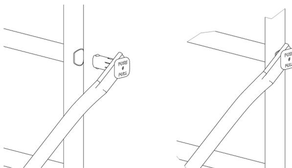
Pour le démontage appuyer sur le bouton et tirer sur la diagonale.
