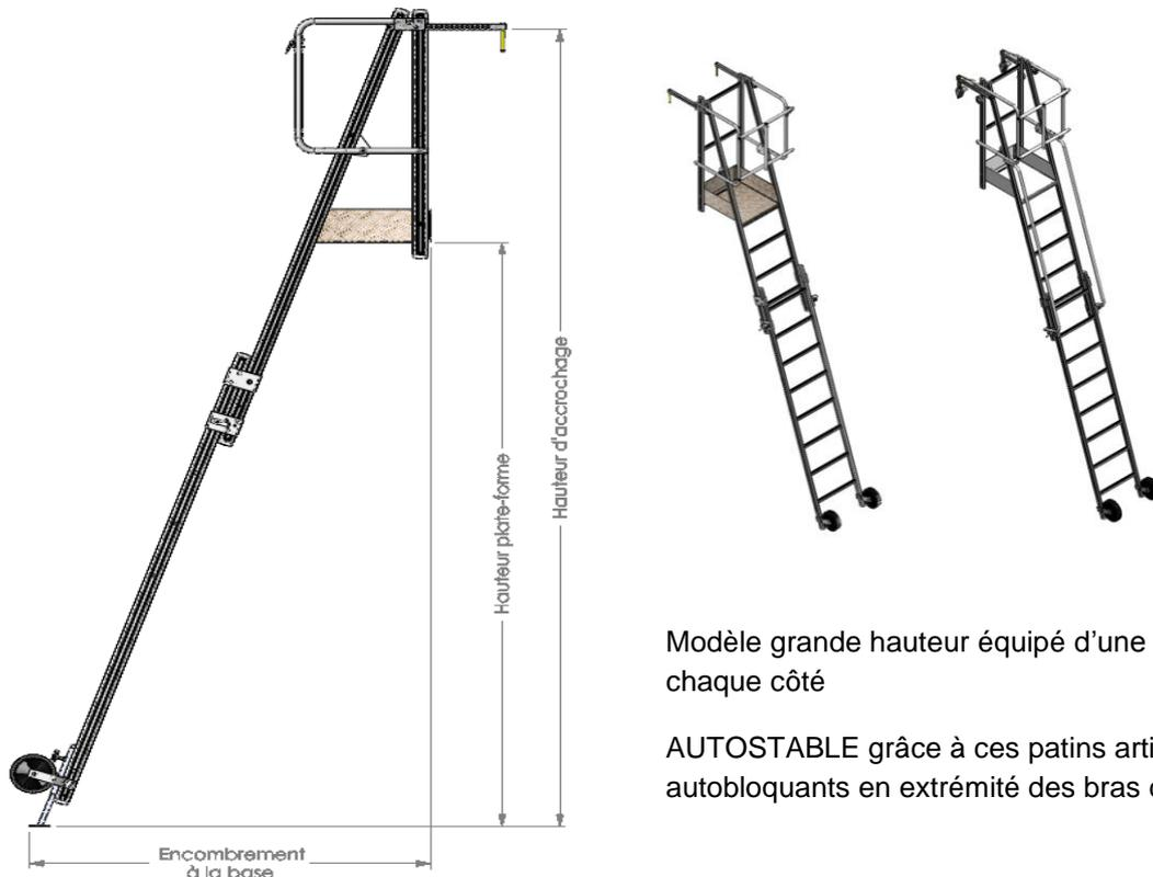
Modèle grande hauteur équipé d'une rampe de chaque côté
