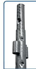
Extrémités des cadres avec manchons sertis : les cadres s'emboîtent et se déboîtent aisément, même après de multiples utilisations, grâce à une portée à plat (tube sur tube).
