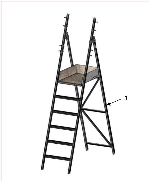
**1.** Déployer la structure (Rep1) et boulonner le garde-corps supérieur (Rep2) (voir 1.a) puis boulonner le garde-corps inférieur (rep3) (voir 1.b) à l'aide des boulons M8 disponibles sur la structure
